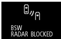
Quand l'affichage d'avertissement apparaît, le capteur radar ne peut pas détecter de véhicule se déplaçant côte à côte ni de véhicule qui s'approche parce que des corps étrangers comme de la saleté, de la neige ou de la glace sont collés sur la surface du pare-chocs autour du capteur.
