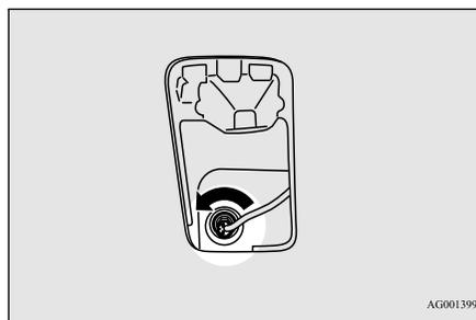
4. Sortez l'ampoule en la tirant de la douille.
