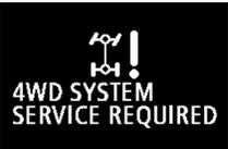
4WD SYSTEM SERVICE REQUIRED    | <ul style="list-style-type: none"> <li>● Il y a une anomalie du système 4 roues motrices contrôlé électroniquement.</li> </ul>                         | <ul style="list-style-type: none"> <li>● Contactez un concessionnaire agréé Mitsubishi Motors ou l'atelier de réparation de votre choix pour faire vérifier le système. Reportez-vous à la section «Système de traction électronique 4 roues motrices (4WD)», page 5-66.</li> </ul>                                |
