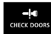
Quand le mode de fonctionnement est le mode ARRÊT, qu'une des portes ou le hayon ne sont pas refermés correctement et que quelqu'un tente de verrouiller le véhicule en appuyant sur l'interrupteur de verrouillage/déverrouillage de la porte du conducteur ou du passager avant ou sur l'interrupteur de VERROUILLAGE du hayon, l'affichage d'avertissement apparaît alors et la sonnerie retentit pendant environ 3 secondes comme avertissement, et les portes et le hayon ne peuvent pas être verrouillés.
