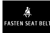
Un signal sonore et un témoin d'avertissement sont utilisés pour rappeler au conducteur de boucler sa ceinture.
