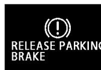
Cet avertissement s'affiche si le véhicule est conduit avec le frein de stationnement encore serré. Le témoin d'avertissement du groupe d'instruments s'allume uniquement quand le frein de stationnement est serré.
