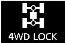
4WD LOCK | ● Quand le mode de conduite «4WD LOCK» (verrouillage 4 roues motrices) est sélectionné à l'aide du sélecteur de mode de conduite. |                                                                                                  |
