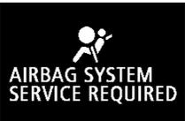
AIRBAG SYSTEM SERVICE REQUIRED   | <ul style="list-style-type: none"> <li>● Il y a une anomalie du système SRS de coussins de sécurité gonflables ou du système de prétendeur.</li> </ul> | <ul style="list-style-type: none"> <li>● Contactez un concessionnaire agréé Mitsubishi Motors ou l'atelier de réparation de votre choix pour faire vérifier le système immédiatement. Reportez-vous à la section «Témoin/affichage d'avertissement du SRS», page 4-36.</li> </ul>                                  |
