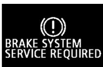
Lorsque le commutateur d'allumage est placé en position «ON» (marche) ou le mode de fonctionnement sur ON (marche), cet avertissement s'affiche quand le niveau de liquide de frein est bas.
