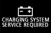
CHARGING SYSTEM SERVICE REQUIRED | <ul style="list-style-type: none"> <li>● Il y a une anomalie du circuit de charge.</li> </ul>                                                          | <ul style="list-style-type: none"> <li>● Stationnez votre véhicule dans un endroit sûr dès que possible et contactez un concessionnaire agréé Mitsubishi Motors ou l'atelier de réparation de votre choix pour obtenir de l'aide. Reportez-vous à la section «Témoin du système de charge», page 5-164.</li> </ul> |
