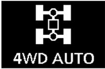
4WD AUTO  | ● Quand le mode de conduite «4WD AUTO» (4 roues motrices automatiques) est sélectionné à l'aide du sélecteur de mode de conduite. |                                                                                                  |
