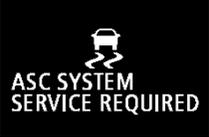
ASC SYSTEM SERVICE REQUIRED      | <ul style="list-style-type: none"> <li>● Il y a une anomalie du système de contrôle de stabilité actif (ASC).</li> </ul>                               | <ul style="list-style-type: none"> <li>● Contactez un concessionnaire agréé Mitsubishi Motors ou l'atelier de réparation de votre choix pour faire vérifier le système. Reportez-vous à la section «Contrôle de stabilité actif (ASC)», page 5-80.</li> </ul>                                                      |
