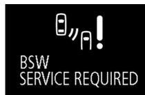
Quand l'affichage d'avertissement apparaît, le système BSW ne fonctionne pas normalement à cause d'une défaillance du système. Faites inspecter le véhicule par un concessionnaire agréé Mitsubishi Motors dès que possible.
