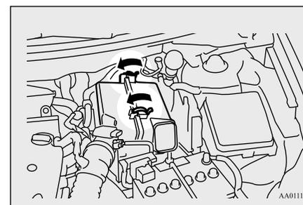
4. Remplacez le filtre à air et remettez le couvercle à sa position d'origine.
