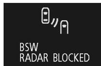
Quand l'affichage d'avertissement apparaît, le capteur radar ne peut pas détecter de véhicule se déplaçant côte à côte ni de véhicule qui s'approche parce que des corps étrangers comme de la saleté, de la neige ou de la glace sont collés sur la surface du pare-chocs autour du capteur.
