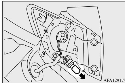
6. Pour installer l'ampoule, suivez les étapes de dépose dans le sens inverse.
