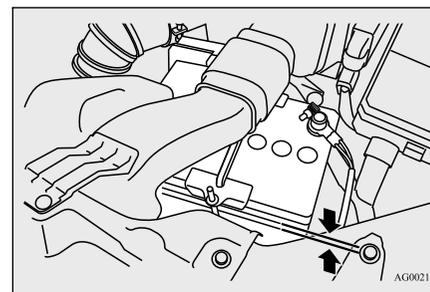
Le niveau d'électrolyte doit se trouver entre les limites indiquées à l'extérieur de la batterie. Remplissez-la avec de l'eau distillée selon le besoin. La partie intérieure de la batterie est divisée en plusieurs compartiments. Enlevez le bouchon de chaque compartiment et remplissez jusqu'au repère.
