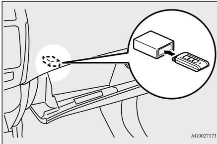
4. Avec la première clé F.A.S.T. valide, appuyez sur le bouton UNLOCK (déverrouillage) et maintenez-le enfoncé pendant 4 à 8 secondes, puis appuyez sur le bouton LOCK (verrouillage) et maintenez-le enfoncé pendant ce temps.
