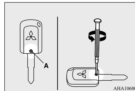
3. Orientez le logo Mitsubishi vers vous et insérez la pointe d'un tournevis plat couverte d'un chiffon dans l'encoche du cache de l'émetteur de commande à distance et utilisez-la pour ouvrir le cache.
