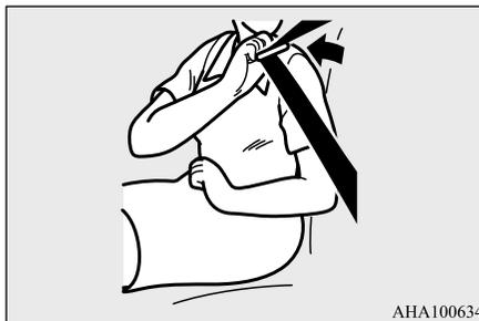
4. Tirez lentement sur la ceinture de sécurité afin de la dérouler tout en maintenant la languette. Enfoncez la languette de métal dans la boucle jusqu'à ce qu'un «déclic» se produise. Tirez sur la ceinture pour vous assurer que la languette est bloquée correctement dans la boucle.
