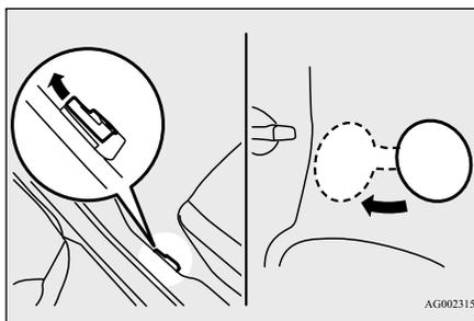
3. Ouvrez le bouchon du goulot de remplissage du réservoir de carburant en tournant doucement dans le sens inverse des aiguilles d'une montre.
