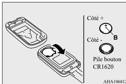
6. Fermez le cache de l'émetteur de commande à distance fermement.
