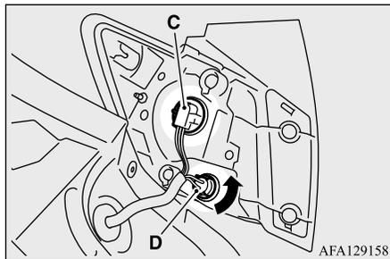
C- Feu de gabarit arrière, feu de freinage et feu arrière et de freinage (DEL)
