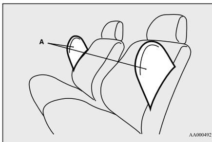
Une étiquette est apposée sur les dossiers dans les véhicules équipés de coussins de sécurité gonflables latéraux.
