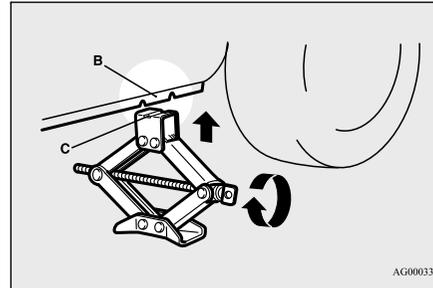
4. Veillez à ce que le rebord situé au niveau du point de levage s'engage dans la rainure supérieure du cric. Introduire la barre (D) dans la clé pour écrous de roue (E). Accrochez ensuite l'autre extrémité de la barre dans l'œillet de l'axe du cric, comme indiqué sur le schéma. Tournez ensuite lentement la clé pour écrous de roue jusqu'à ce que le pneu soit quelque peu soulevé au-dessus du sol.
